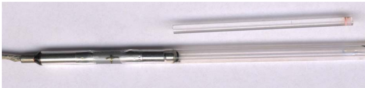
Элементы рубинового лазера: монокристалл рубина и импульсная лампа
