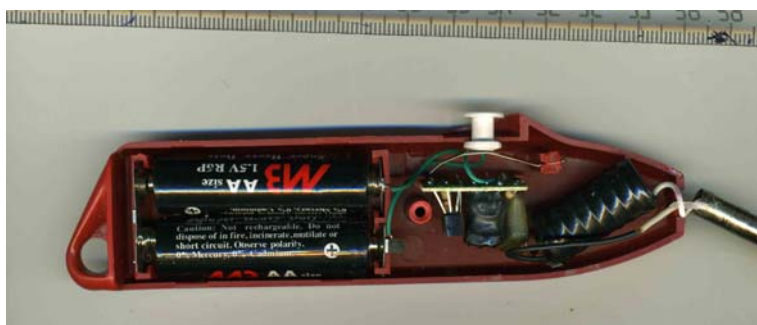
Зажигалка бытовая с повышающим трансформатором
